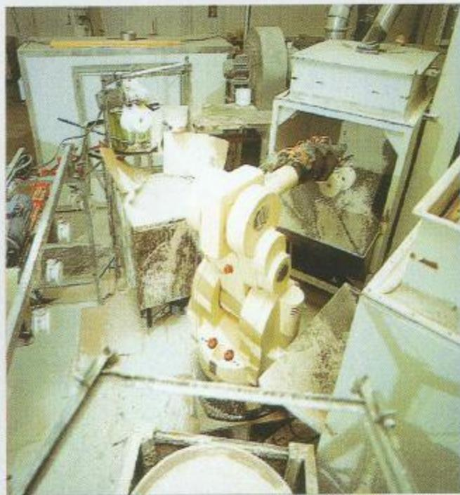
Die Hahnkörper werden in der eigenen Gießerei gegossen, unter Verwendung von hochmodernen Formverfahren in Keramikschalen.
