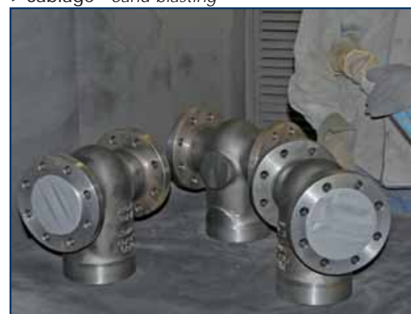
> Sablage - Sand blasting
